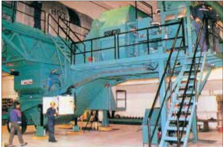
Hot Mix -kuumamassa-asema valmiina tehtaalla.
